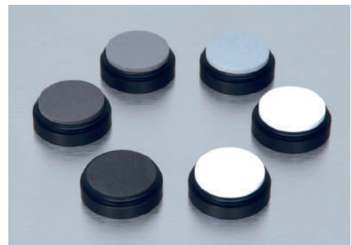
Satz von Labsphere-Referenzstandards für den Test der photometrischen Linearität (gemäß USP <856>, JP 2.27 und Ph. Eur. 2.2.40).
